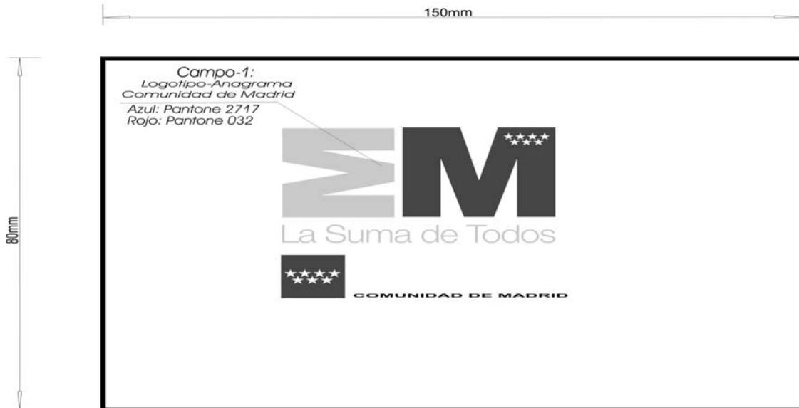
*Placa Rectangular de 150x80 m/m de Aluminio atornillada a una superficie exterior y visible en todos los elementos del suministro*
